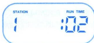
Чтобы установить продолжительность орошения для одного клапана в ручном управлении, используйте клавишу « + ». Для установки продолжительности орошения следующего клапана в ручном режиме управления нажмите клавишу
