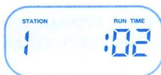
Контроллер включит все клапаны, и они будут работать в течении 2 минут. В это время можно проверить исправность дождевателей.
